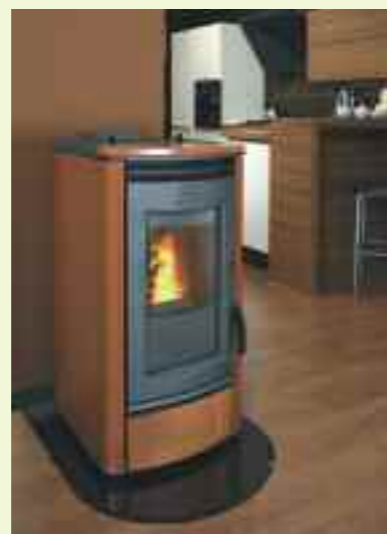
ΣΟΜΠΑ ΠΕΛΛΕΤ 5000 THERMOCOMFORT METALCOLOR Διαστάσεις: 973x460x484, Κιλά: 128, Φ80 Ισχύς: 3-9 kW Κατανάλωση: 0.7-2.1* Χρώματα: καφέ, μπλε, κόκκινο
