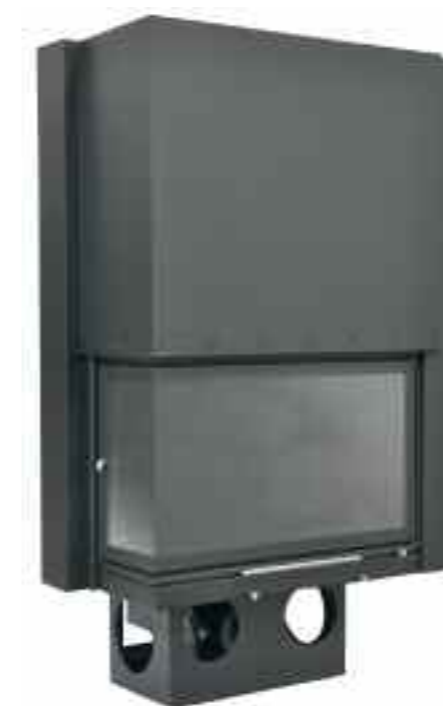
1. Δύο έξοδοι Φ120 θερμού αέρα. 2. Με ρυθμιζόμενο κλιπέ καυσαερίων. 3. Βεντυλατέρ στη βάση της εστίας. 4. Ρύθμιση αέρα καύσης. 5. Ηλεκτρονικός πίνακας ελέγχου.
